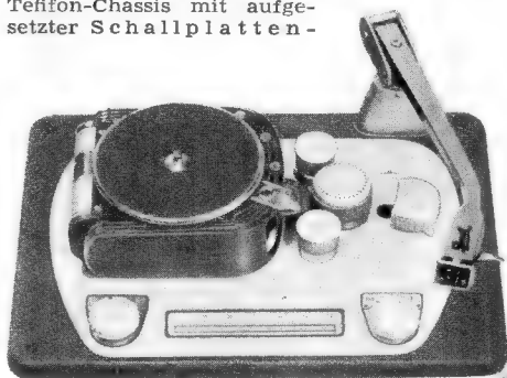
Bild 1. Tefifon mit Schallplattenkassette und Tonabnehmer
